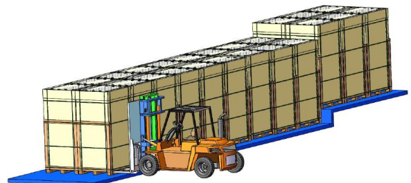
Déchargement des emballages verticaux avec un chariot élévateur
