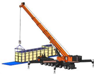
Déchargement des emballages verticaux avec une grue
