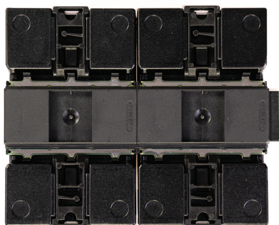
Fig.: Solar-Log™ Base e Solar-Log™ MOD 485 con connettore bus collegati.
