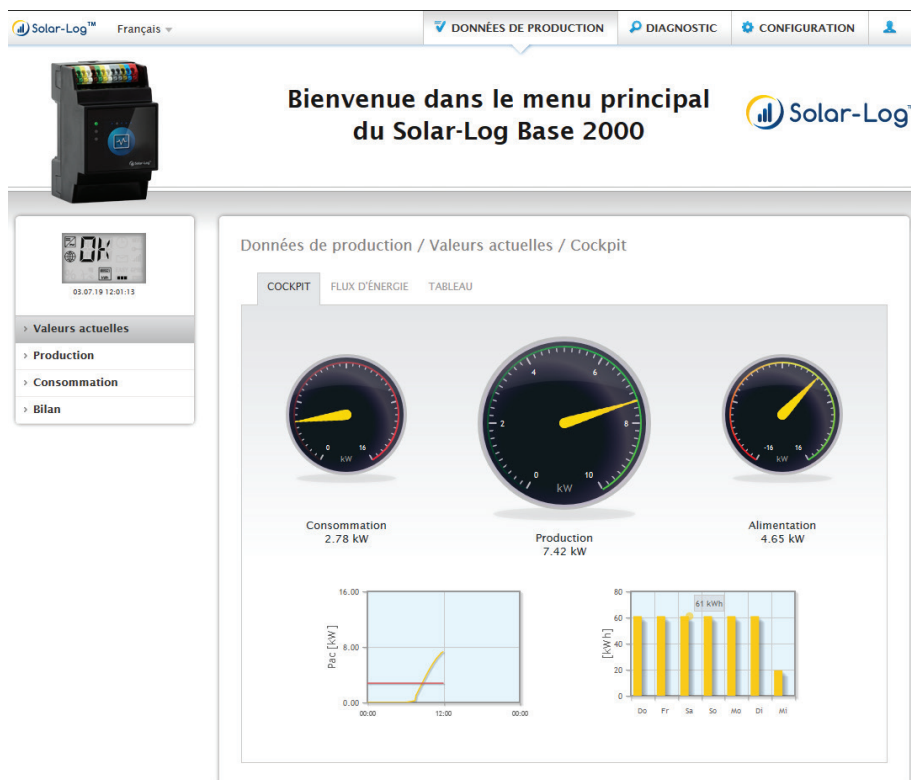
Fig. : Menu principal du Solar-Log™ Base 2000
