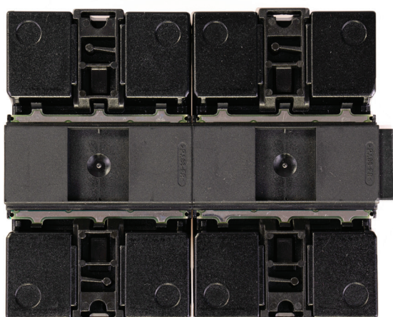
Fig. : Solar-Log™ Base et Solar-Log™ MOD 485 assemblés avec connecteur de bus.
