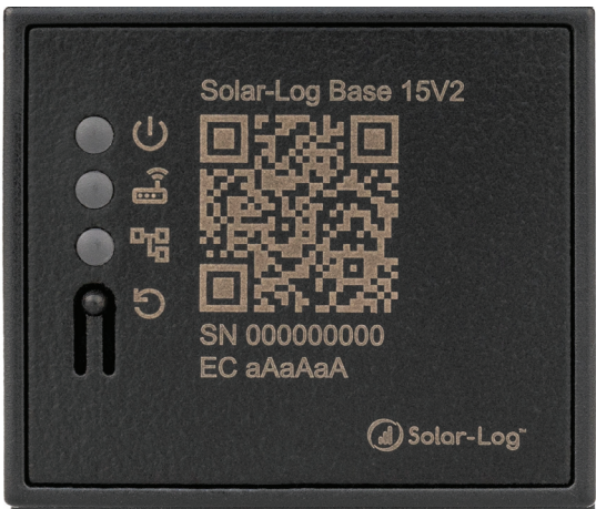
Fig. : Solar-Log™ Base 15V2 Vue de face avec LEDs et touche de réinitialisation
