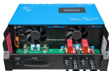
Interior del MPPT RS SmartSolar 450|100
