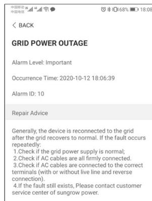
Figura 7-9 Información detallada de alarma de falla
