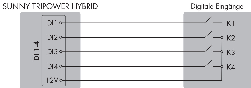
Abbildung 11: Anschluss eines Fernwirkgeräts am digitalen Eingang DI D1-D4, Vcc des Sunny Tripower Hybrid
