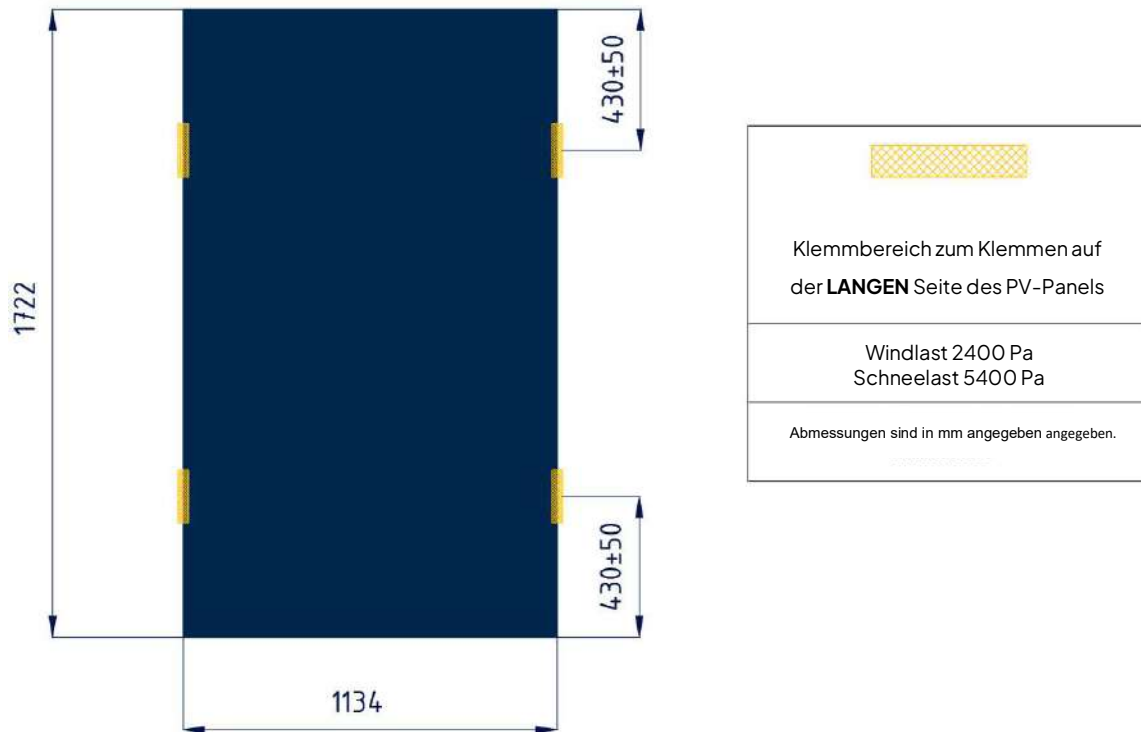
Abbildung 5: Montage von „Blackstar B.108“ Modulen mit Klemmen an vier Befestigungspunkten entlang der langen Seiten des Moduls
