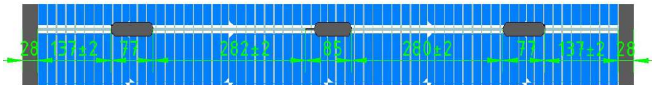
Abbildung 16: Position der Anschlussdose bei Modulen der „Blackstar B.108 Serie
