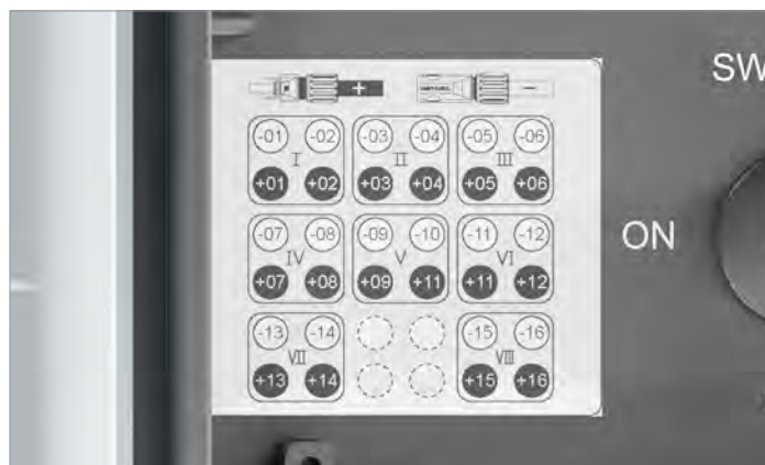
Abb. 4.10: Etikett mit der Zuordnung der einzelnen DC-Steckverbinder
