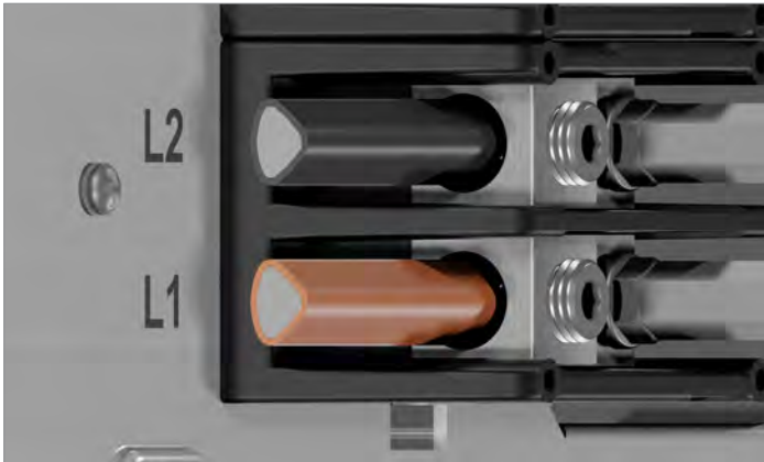
Abb. 8.12: Korrekte Lage von sektorförmigen Aluminiumkabeln (2)
