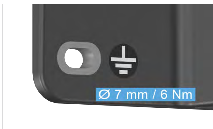
Abb. 6.14: Erdungsanschluss am linken Montageloch
