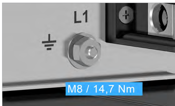
Abb. 6.15: PE-Anschluss
