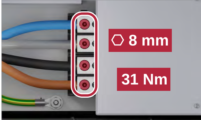
Abb. 8.8: Drehmomente am AC-Klemmenblock
