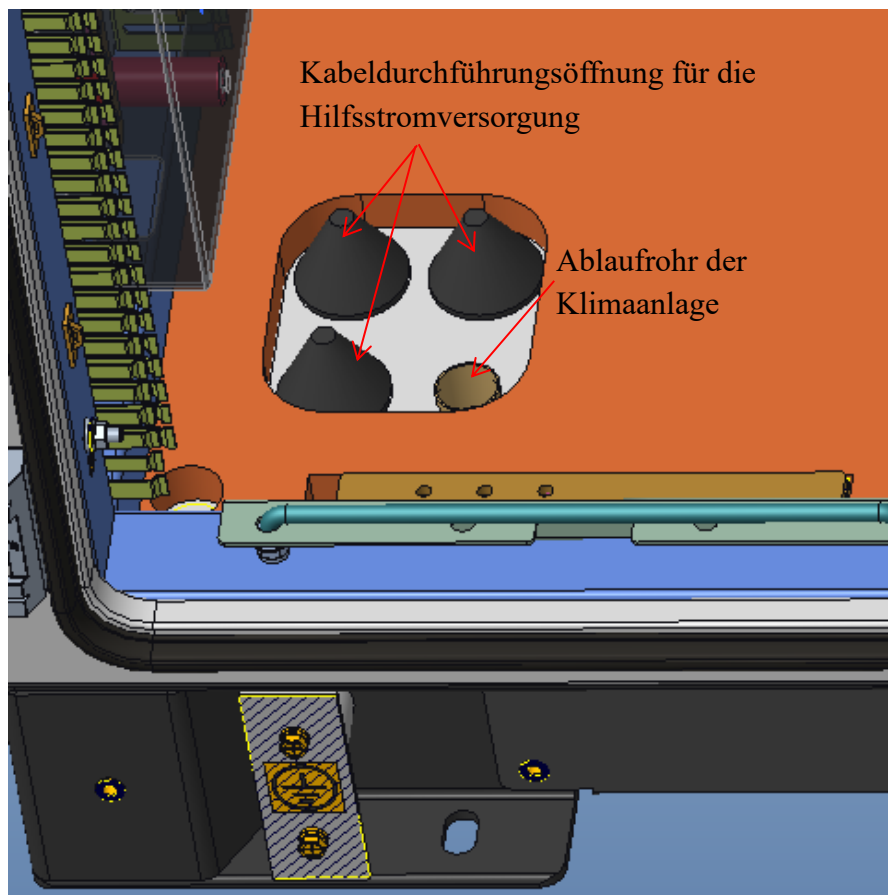
Abbildung 5.2.4.2 Schematische Darstellung der Einführungsöffnung für die Sekundärleitung unten links am Schrank
