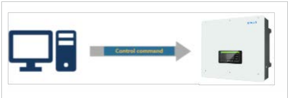
Abbildung 68: Externe Steuerung des Wechselrichters
