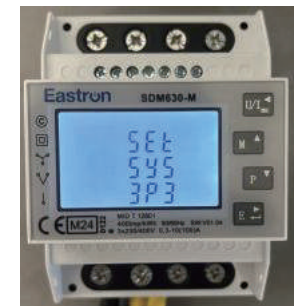
6.按 P 键选择 3P3 制式, 长按 E 键 3s 退出 SYS 设置, 再长按 U/I 键 3s 退出到初始界面
