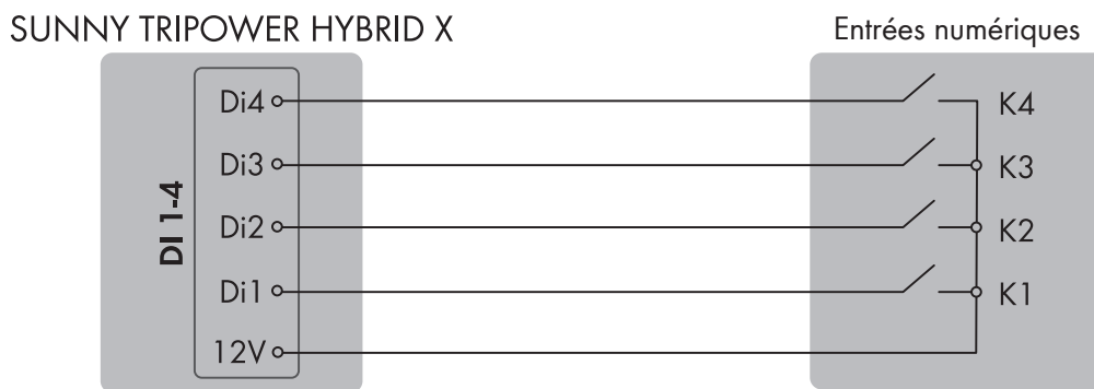
Figure 10 : Raccordement d'un appareil de commande à distance à l'entrée numérique DI D1-D4, Vcc du Sunny Tripower Hybrid
